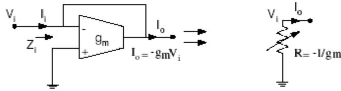
**FIG: 6.4 VOLTAGE VARIABLE RESISTOR**
