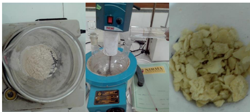
Fig 1a) Guar gum powder b) Experimental setup c) NaCMG pellets
