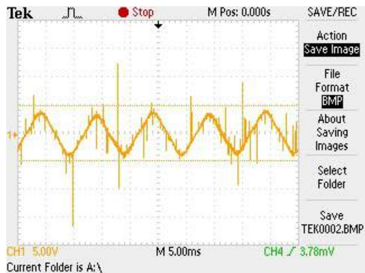
Figure 10.6: Output Voltage Ripple 4.8V (Scale: X-axis 5 msec per div and Y-axis 5 V per div )
