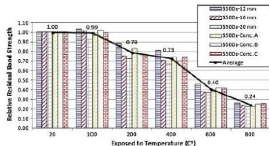
(d) Bond strength degradation for S500a Bars
