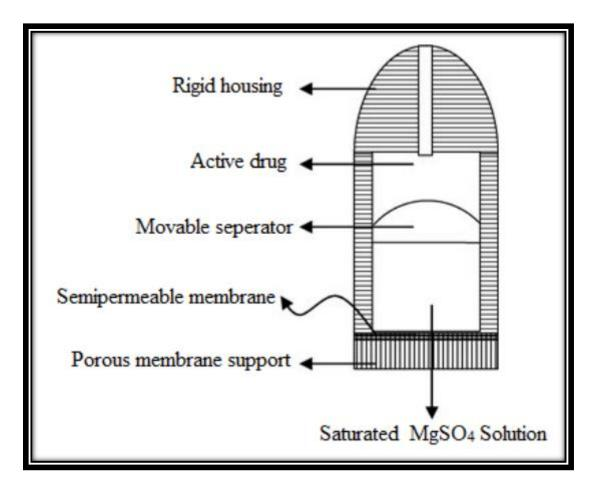
Figure 1.4 Higuchi Leeper Pump<sup>[28]</sup>
